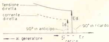
Situazione dei vettori diretto e riflesso sul carico. La tensione riflessa ritarda, la corrente riflessa anticipa.
